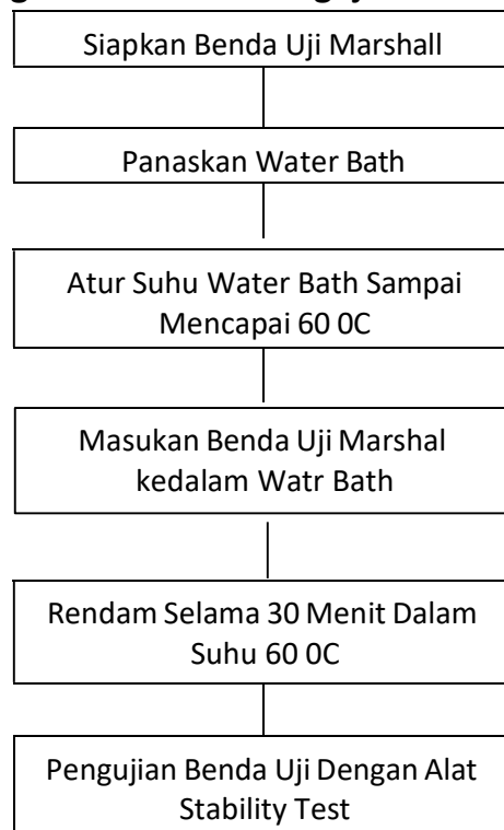
Gambar : 3.4 Diagram Alir Pengujian Stabilitas Marshall
