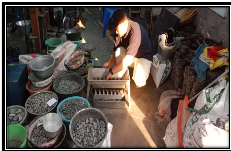
Gambar 3 : Proses Pembagian Material dan gradasi Untuk Benda Uji
