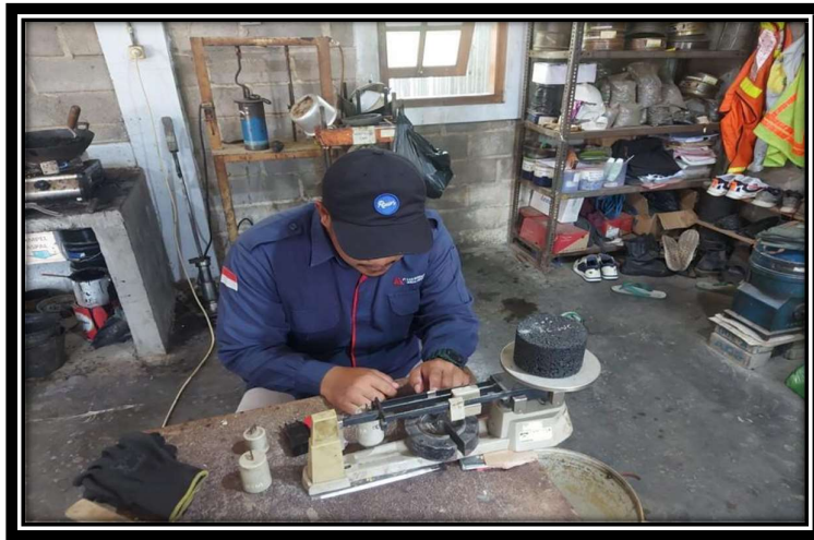
Gambar 16 : Penimbangan Benda Uji Marshall di udara
