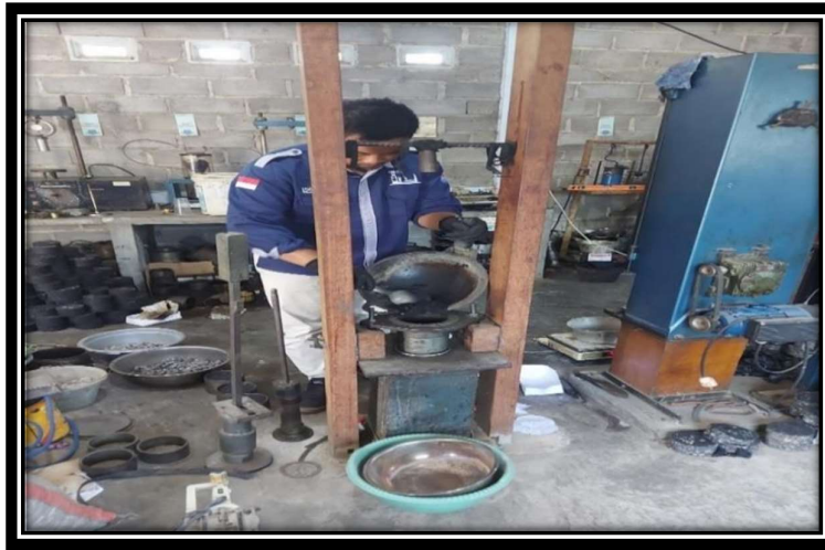
Gambar 10 : Penuangan Material Untuk Benda Uji Marshall pada Cetakan
