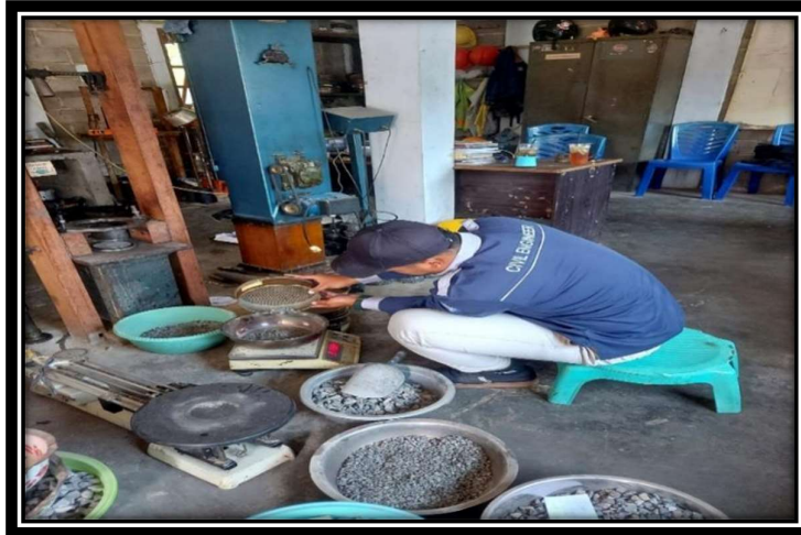
Gambar 4 : Proses Penimbangan Material Untuk Benda Uji
