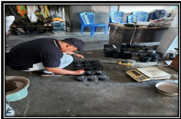
Gambar 14 : Pengukuran dan penandaan Benda Uji Marshall
