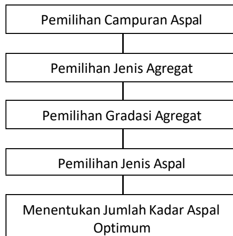
Gambar : 3.2 Diagram Alir Pembuatan Mix Design
