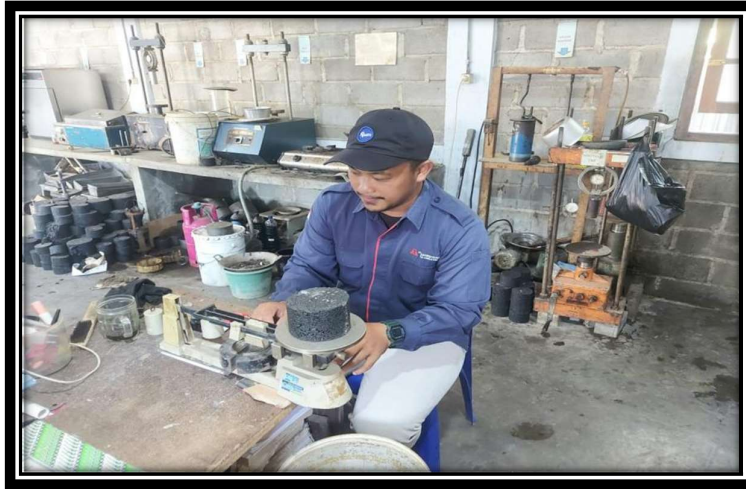
Gambar 19 : Penimbangan Benda Uji Marshall setelah SSD
