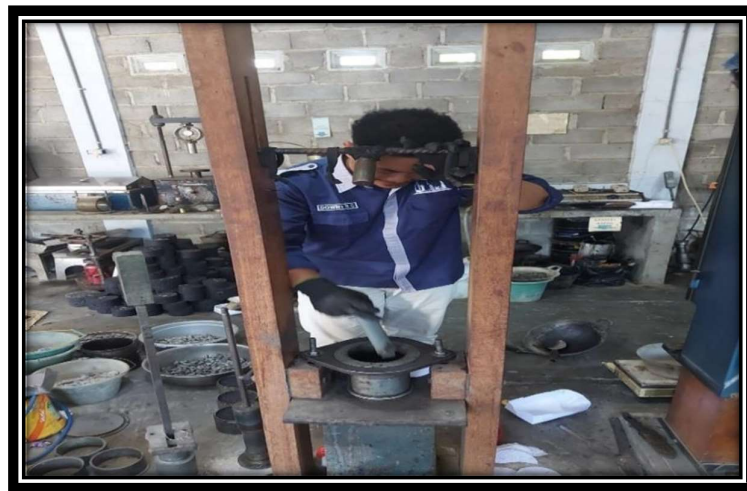
Gambar 11 : Proses Perapian Material Menggunakan Spatula Benda Uji Marshall pada Cetakan
