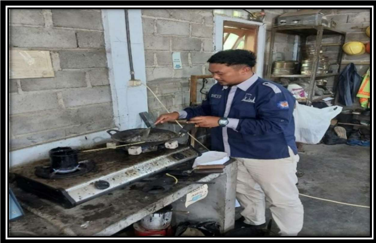
Gambar 8 : Proses Penggorengan Material Untuk Benda Uji
