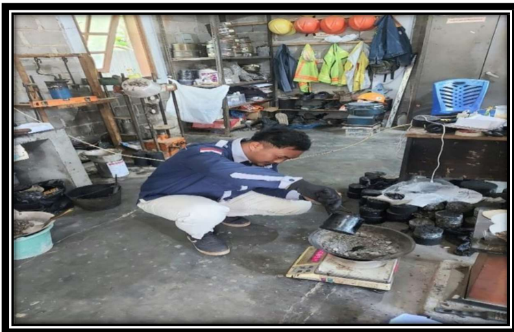
Gambar 9 : Proses Pemberian Aspal Cair Pada Material
