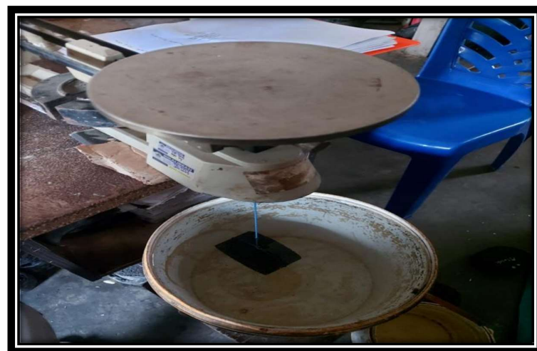
Gambar 18 : Penimbangan Benda Uji Marshall di dalam air
