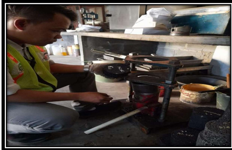
Gambar 13 : Pelepasan Benda Uji dari cetakan
