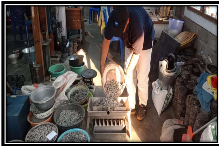
Gambar 2: Proses Pembagian Material Untuk Benda Uji
