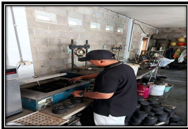
Gambar 21 : Proses Perendaman Benda Uji Marshall Pada suhu 60 C
