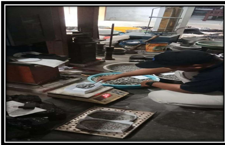
Gambar 5 : Proses pembuatan sampel briket Untuk Benda Uji
