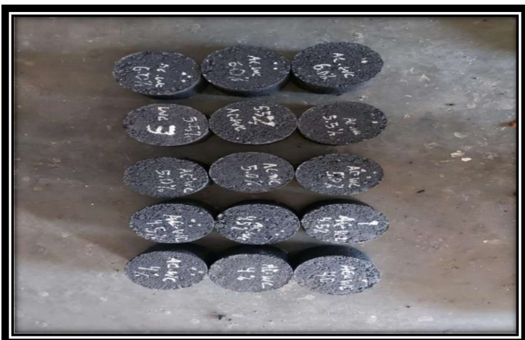
Gambar 15 : Sampel setelah dilepas dari cetakan Benda Uji Marshall
