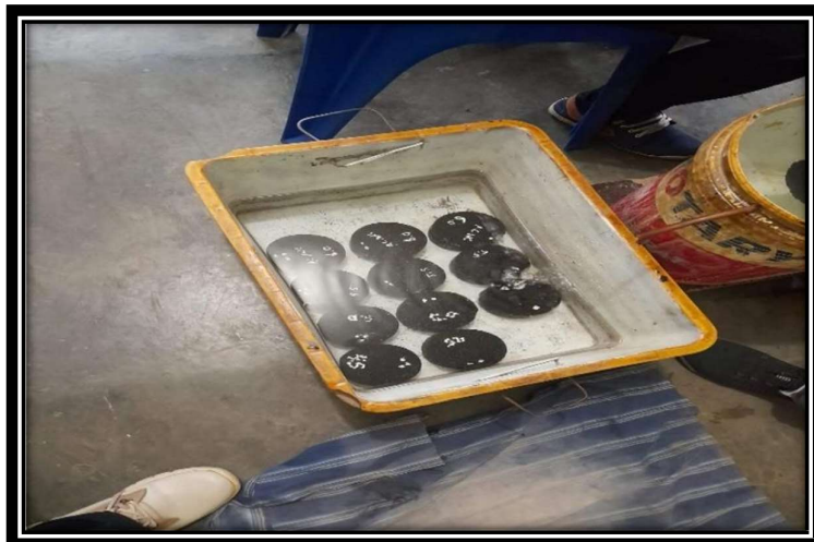
Gambar 17 : Perendaman Benda Uji Marshall di dalam air
