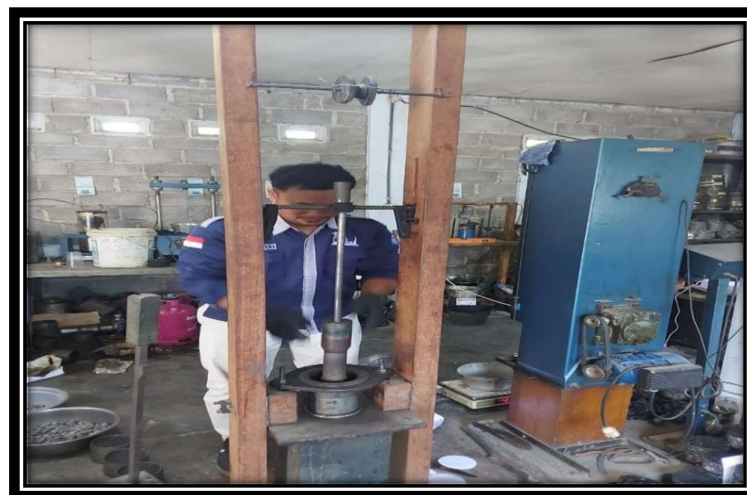
Gambar 12 : Proses pemadatan Material Untuk Benda Uji Marshall pada Cetakan
