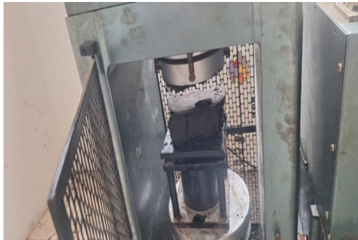
Gambar 4.2 Paving Block di Uji Kuat Tekan Menggunakan Mesin Compression Test.
