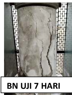
Gambar 4. 11 Pola Keruntuhan Beton Normal
