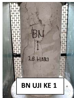
Gambar 4. 16 (a) Pola Keruntuhan BDU 100 % ke-1 dan (b) Pola Keruntuhan BDU 100% ke-2
