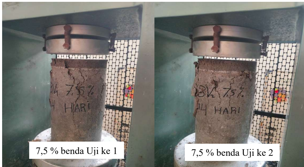
Gambar 4. 20 (a) dan (b) Pola Keruntuhan BV 7,5% Umur 14 Hari
