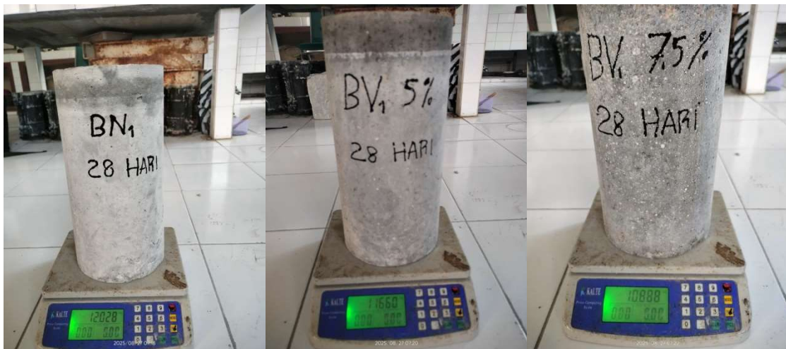
Gambar 4. 5 Hasil Timbangan Umur 28 Hari
