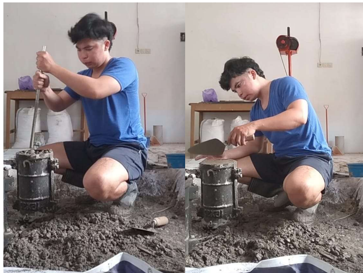
Gambar 3. 17 Penuangan Adukan Beton
