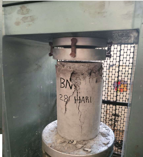
Gambar 4. 21 (a) dan (b) Pola Keruntuhan BN Umur 28 Hari
