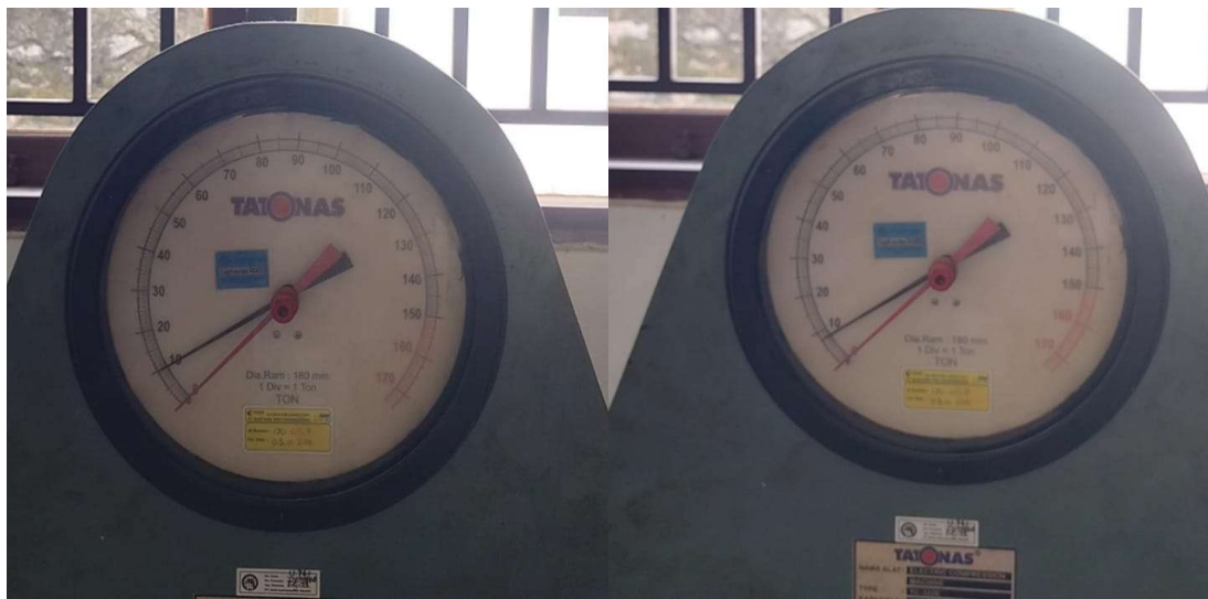
Gambar 4. 10 (a) dan (b) Hasil Uji Tekan BV 7,5% Umur 14 Hari
