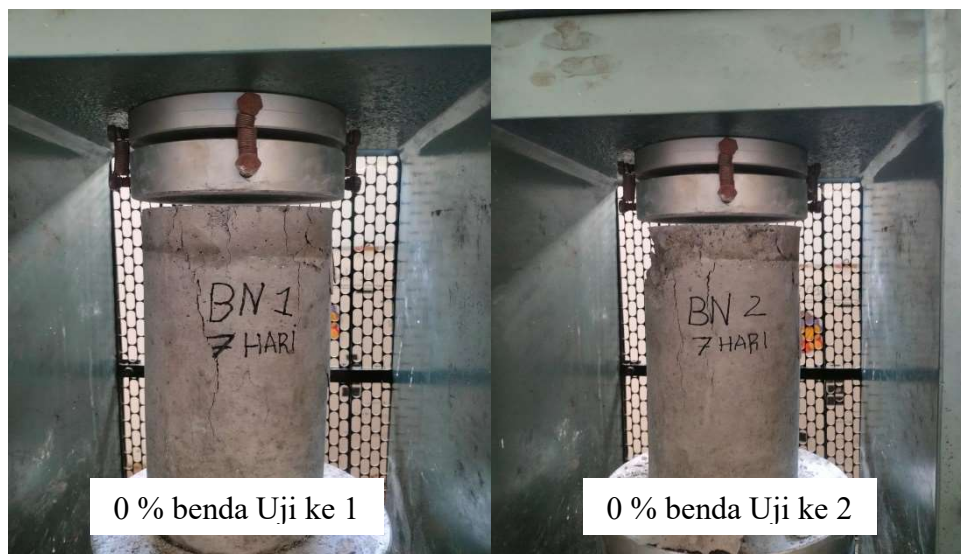
Gambar 4. 15 (a) dan (b) Pola Keruntuhan BN Umur 7 Hari
