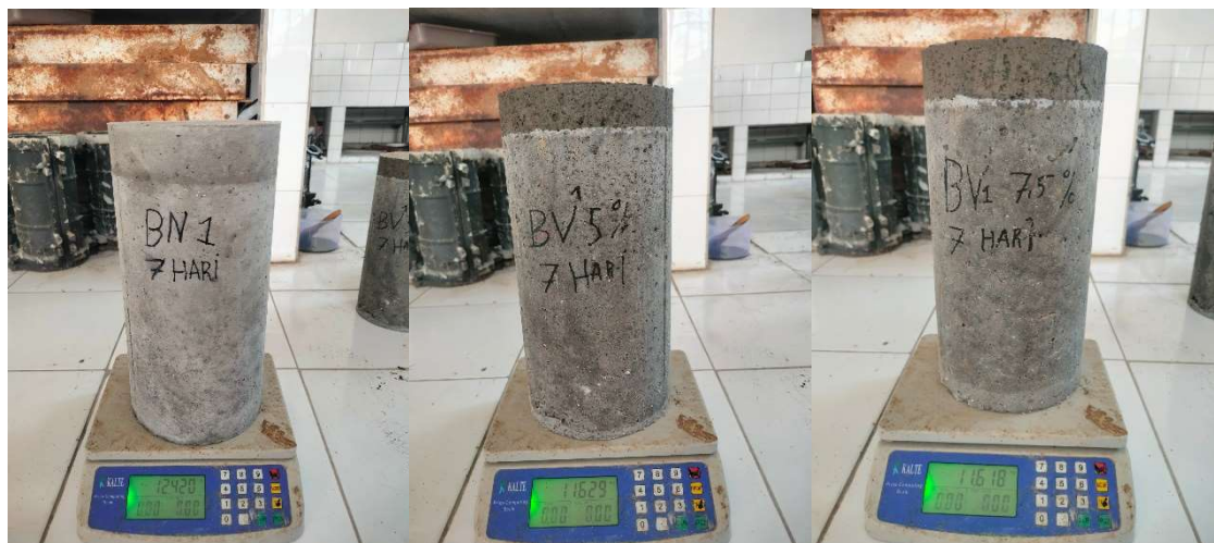
Gambar 4. 3 Hasil Timbangan Umur 7 Hari
