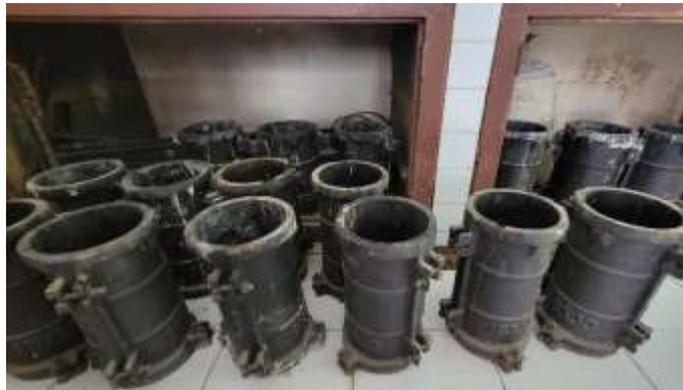
Gambar 3. 7 Cetakan Benda Uji Silinder
