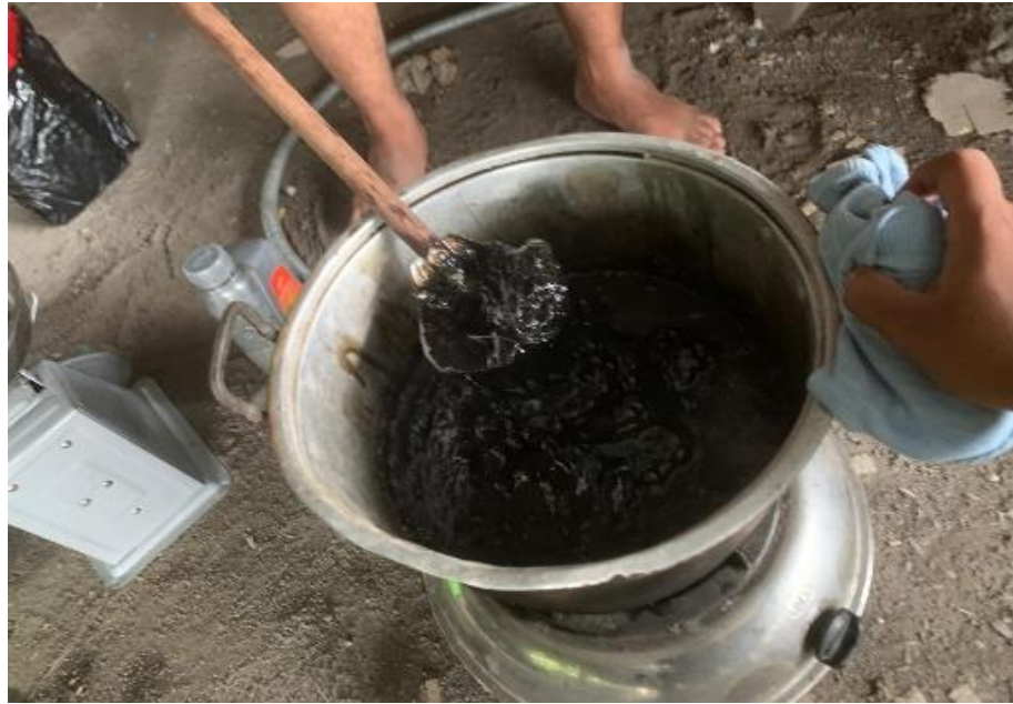
Gambar 3. 10 Proses Pengadukan Limbah Plastik
