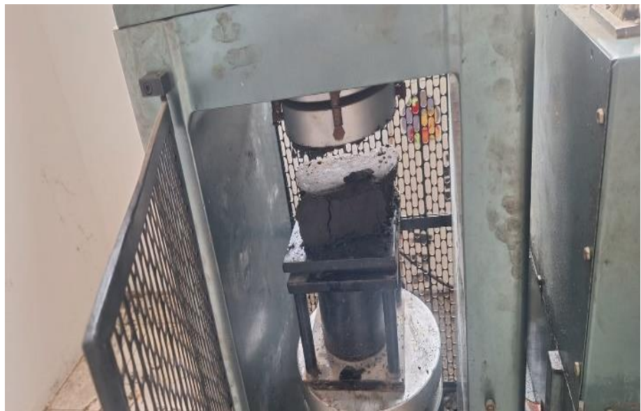
Gambar 3. 17 Hasil setelah proses Uji Kuat Tekan
