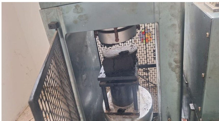
Gambar 4. 1 Paving Block setelah di Uji Kuat Tekan menggunakan mesin compression test
