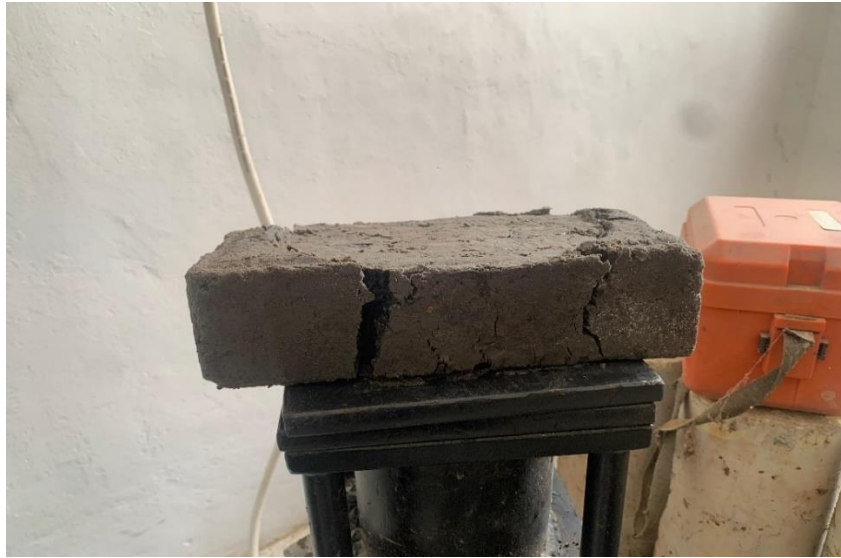
Gambar 4. 2 Hasil Paving Block setelah di uji kuat tekan menggunakan mesin compression test
