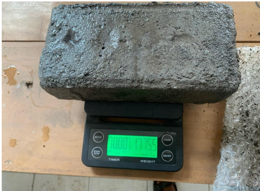
Gambar 4. 3 Paving Block keadaan basah setelah di Uji Permabilitas selama 24jam
