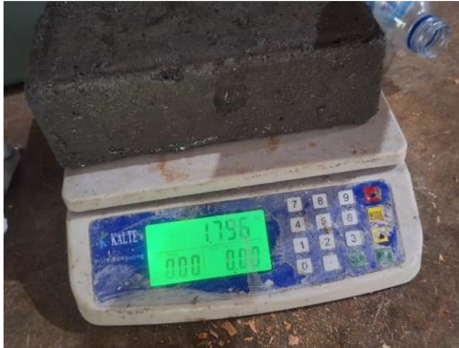
Gambar 3. 15 Hasil Permabilitas selama 24jam dan ditimbang
