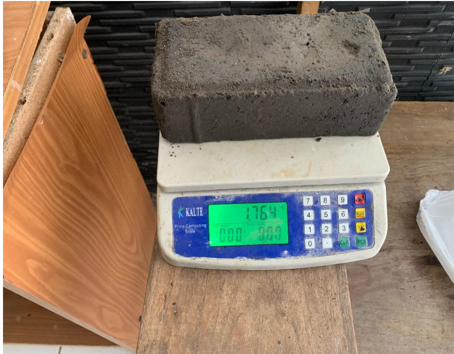
Gambar 4. 4 Paving Block keadaan kering setelah di keringkan sehabis dilakukannya proses Permabilitas
