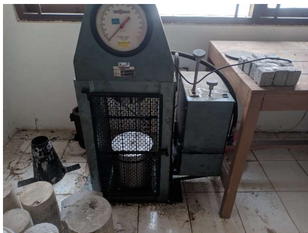
Gambar 3. 15 Alat Pengujian Beton
