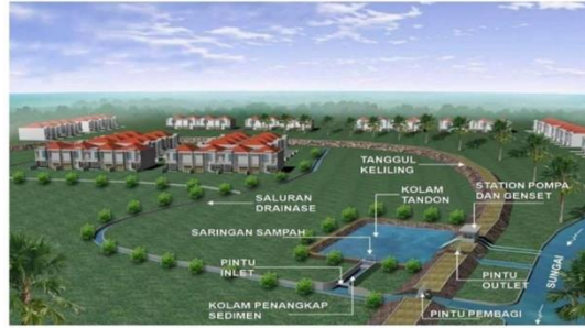
Gambar 2-4. Sistem polder dengan pompa dan kolam di samping sungai
