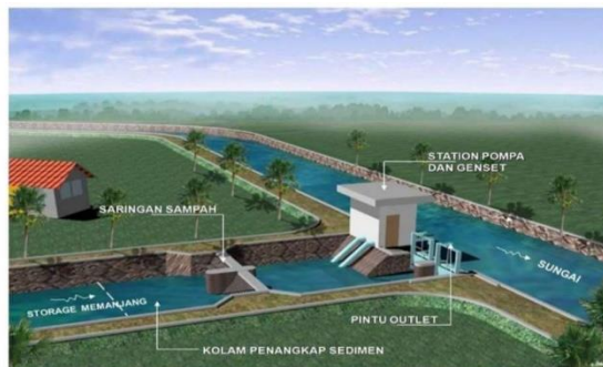
Gambar 2-6. Sistem polder dengan pompa dan kolam tipe storage memanjang
