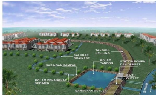
Gambar 2-5. sistem polder dengan pompa dan kolam di dalam badan sungai
