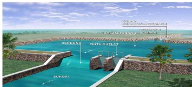
Gambar 2-2. Kolam retensi tipe di dalam badan sungai
