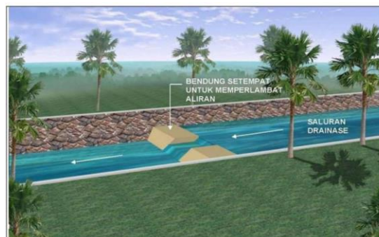
Gambar 2-3. Kolam retensi tipe storage memanjang
