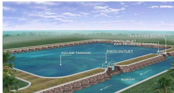
Gambar 2-1. Kolam retensi tipe di samping badan sungai
