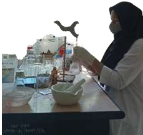
Pengujian nilai FFA dengan titrasi
