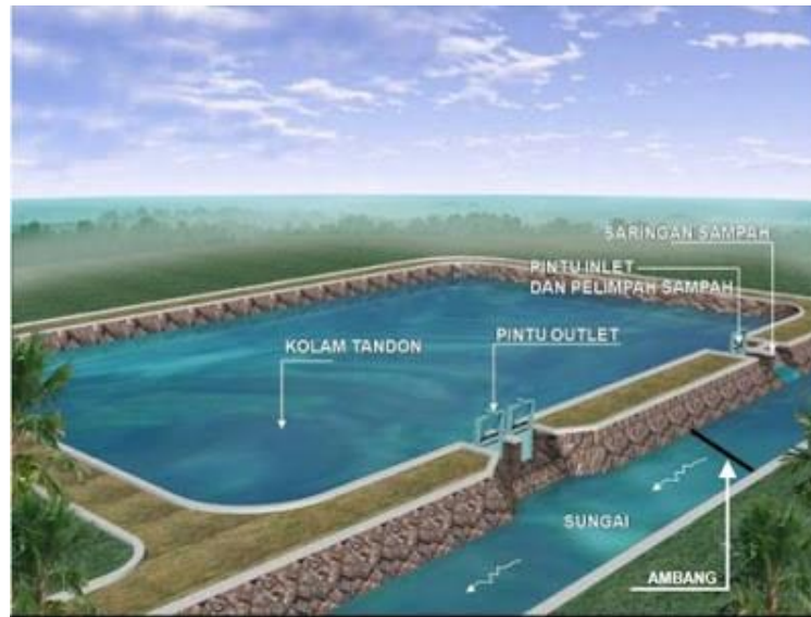
Gambar 2. 14 Kolam Retensi Tipe di Samping Badan Sungai.
