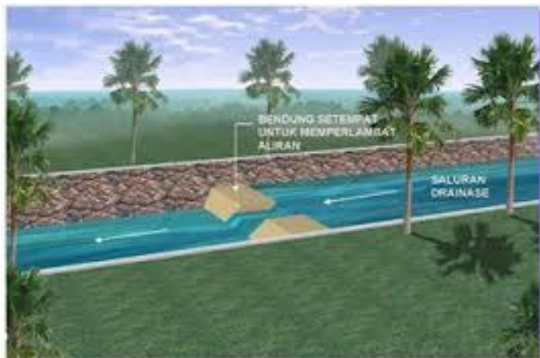
Gambar 2. 16 Kolam Retensi Tipe Storage Memanjang.
