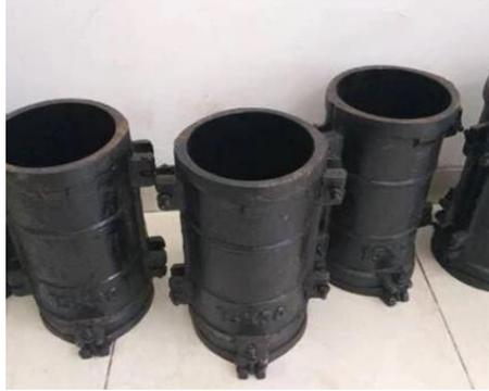
**Gambar 3.8** Cetakan Benda Uji
