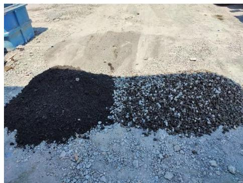
**Gambar 3.3** Agregat Halus dan Agregat Kasar
