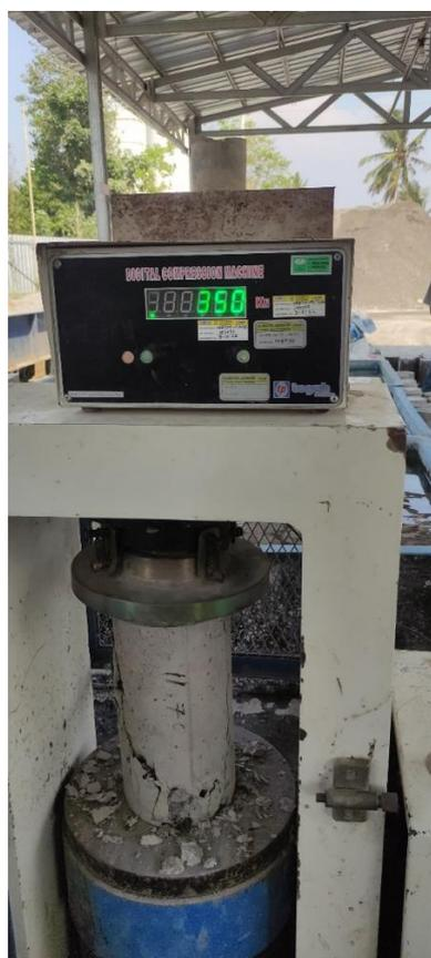
**Gambar 4.3** Pengujian Kuat Tekan Benda Uji
