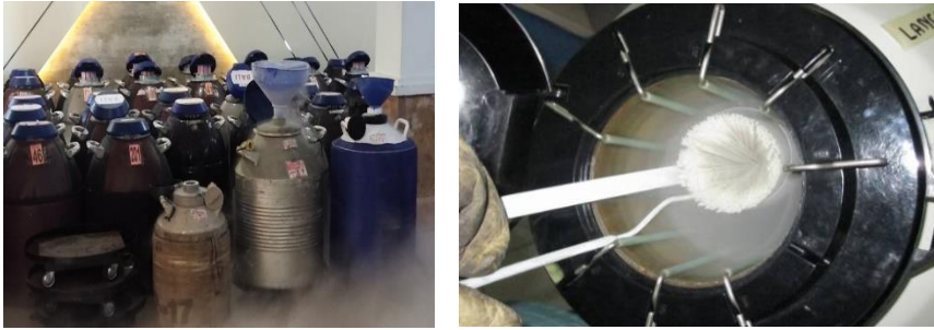
Gambar 22. Pengisian nitrogen cair secara berkala (Dokumentasi Khaeruddin di BBIB Singosari) (kiri). Pengeluaran straw dari dalam kontainer nitrogen cair (Barszcz et al. ,2012) (kanan)
